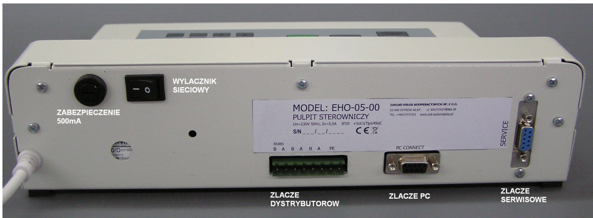
Rys. 2 – Widok pulpitu od strony podłączenia dystrybutorów.
