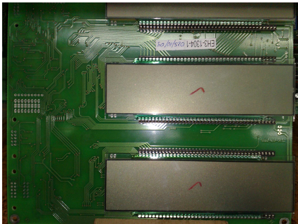
DISPLAY LCD 3X 6 CYFR 25,4 MM
