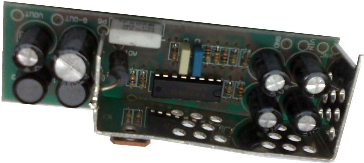
PRZETWORNICA DC/DC – MONTAŻ THT
